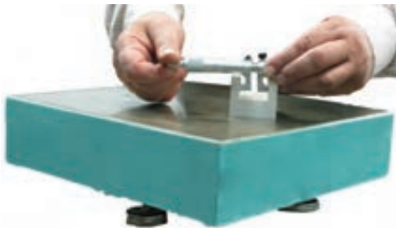
شکل ۶-۵- اندازه‌گیری پهنای شیار قطعه‌ی ناودانی
