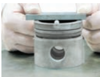
شکل ۶-۸- اندازه‌گیری پیستون با گلوله‌ی اندازه‌گیری
