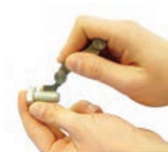
شکل ۱۰-۸- تعیین گام پیچ
