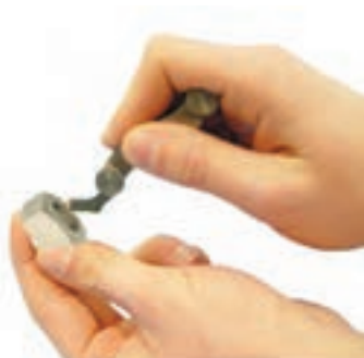
شکل ۱۳-۸- تعیین تعداد دندانه در یک اینچ مهره
