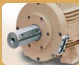
خارها در درون شیار ایجاد شده بر روی محور و قطعه مورد اتصال قرار می‌گیرند و در داخل شیار میله بدون لقی و در درون شیار قطعه سوارشونده در قسمت بالا، بالقی خیلی کمی ( $2/3\text{ mm}$  تا  $3\text{ mm}$ ) جاگذاری می‌شوند. در تصاویر زیر با نحوه نمایش جای خار روی میله و اندازه‌های مهم آنها آشنا می‌شوید.
