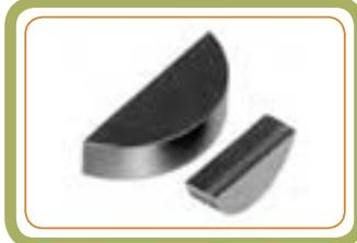
خارهای پولکی (ناخنی): خارهای پولکی روی میله های مخروطی و استوانه ای مورد استفاده قرار می گیرند. از آنها می توان در انتقال نیروهای کم استفاده نمود. این خارها در اثر تماس با شیار داخل قطعه سوار شونده، خود به خود لغزیده و بر آن منطبق می شوند.
