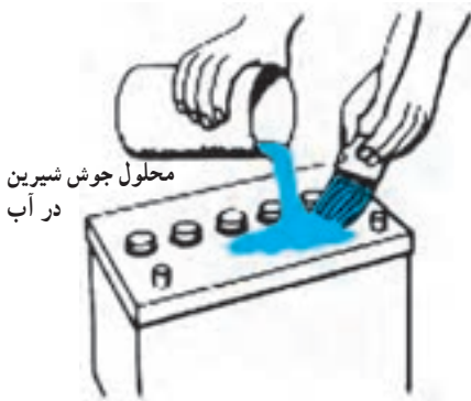
(ب) شستن بدنه باتری با محلول جوش شیرین، مواظب باشید محلول جوش شیرین وارد باتری نشود.
