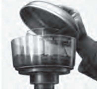
شکل ۲-۴- پیش صافی و تمیز کردن آن
