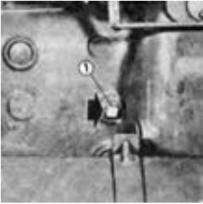
شکل ۳۰-۴- گریس خور بلبرینگ کلاچ با برداشتن درپوش ۱ می توان گریس خور کلاچ را گریس کاری کرد.
