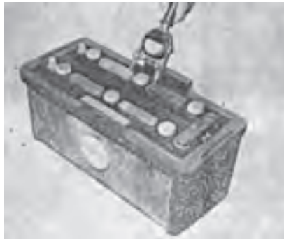
شکل ۴۶-۴ آزمایش ولتاژ یک خانه باتری
