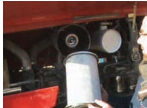
شکل ۸-۴- خارج کردن استوانه صافی و تمیز کردن بدنه صافی
