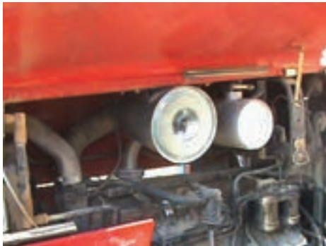
شکل ۸-۴- خارج کردن استوانه صافی و تمیز کردن بدنه صافی
