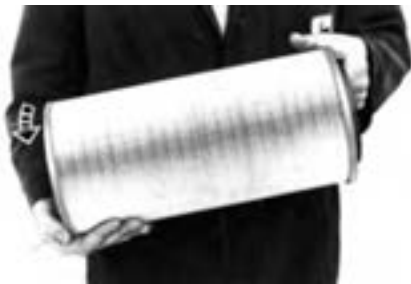
شکل ۱۱-۴- تمیز کردن استوانه صافی با ضربه
