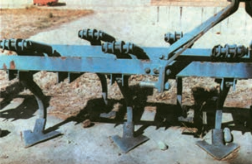
شکل ۵-۶- کولتیواتور فندار با تیغه پنجه‌غازی
