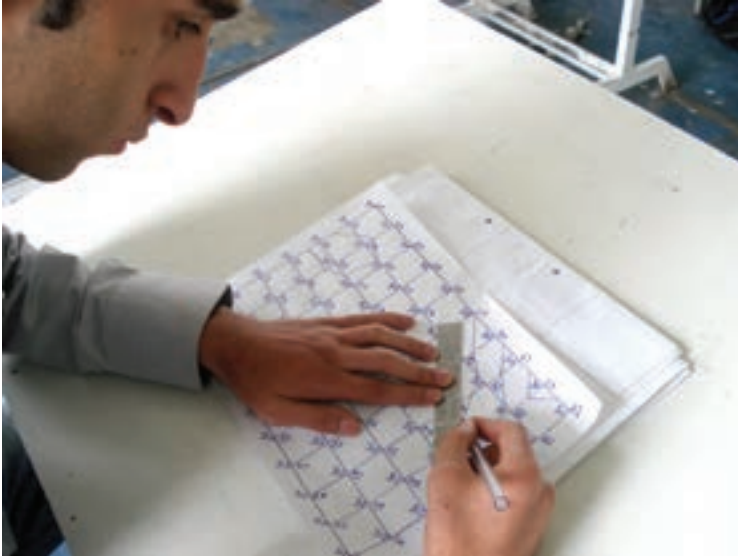
▲ شکل ۱-۹- ترسیم منحنی‌های میزان بر روی کاغذ
