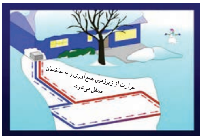
شکل ۶-۳ چگونگی کار پمپ حرارتی در زمستان
