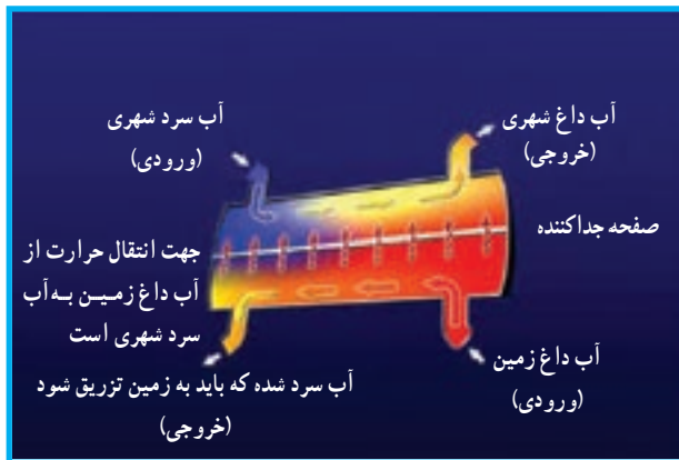
شکل ۳-۴ چگونگی گرم کردن آب شهری توسط آب خروجی از مخازن زمین گرمایی در یک مبدل حرارتی
