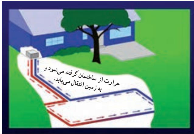
شکل ۳-۷ چگونگی کار پمپ حرارتی در تابستان
