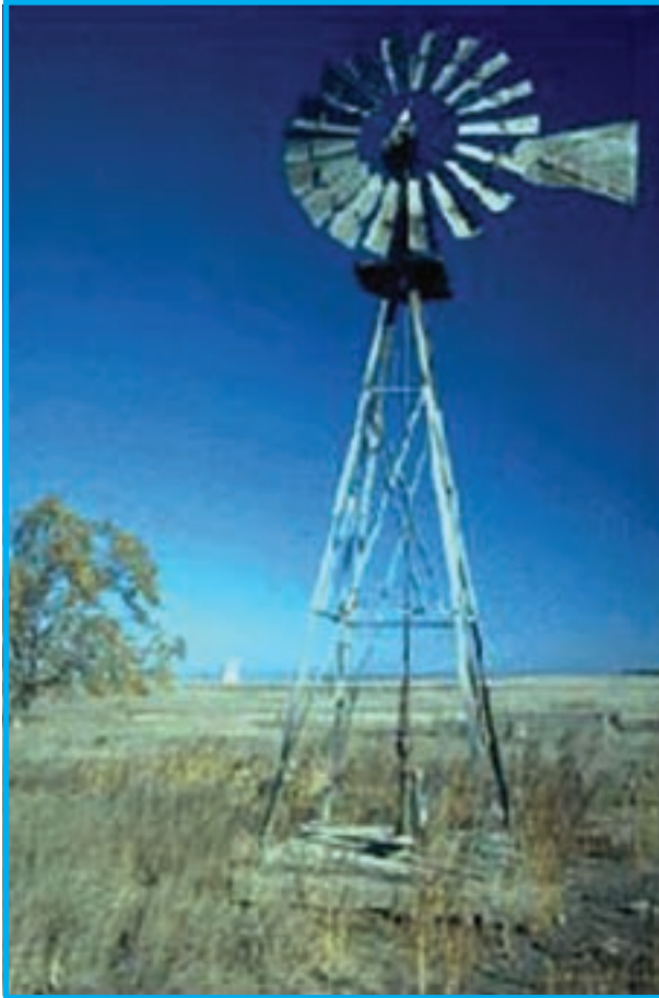
شکل ۳-۱۶ پمپ آب سرچاهی که با انرژی باد کار می‌کند.
