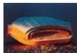
شکل ۱۱-۷- یک مبدل کاتالیزی اتومبیل، در این مبدل مخلوطی از کاتالیزگرهای پلاتین / پالادیم / رودیم به کار رفته است.
