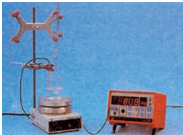
شکل ۴-۱۵- اندازه‌گیری pH به وسیله‌ی دستگاه pH سنج
