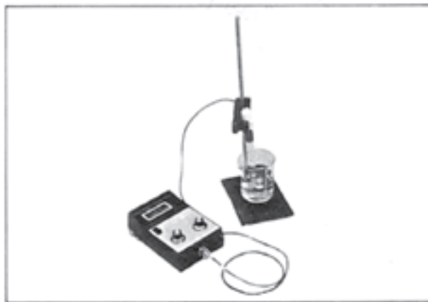
شکل ۲-۱۵- دو نوع pH سنج با دقت 0.1 pH.
