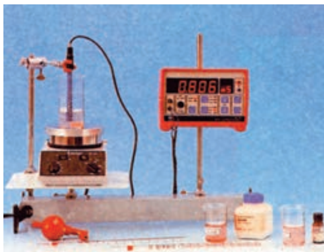
شکل ۱-۱۶- اندازه‌گیری هدایت یک محلول با دستگاه هدایت سنج
