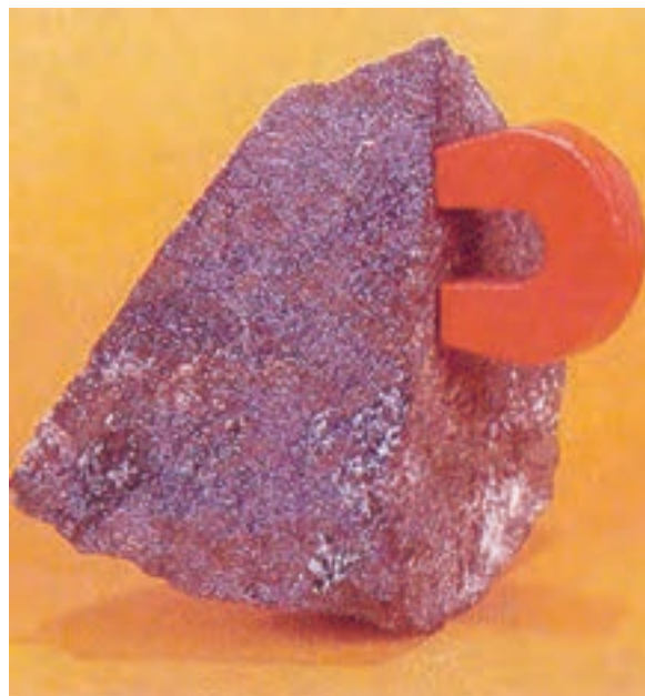
شکل ۵-۷ کاتالیزگر آمونیاک متشکل از کانی حاوی آهن‌اکسید
