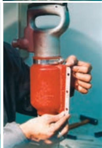
شکل ۲۸-۳- نحوه‌ی جا زدن محافظ
