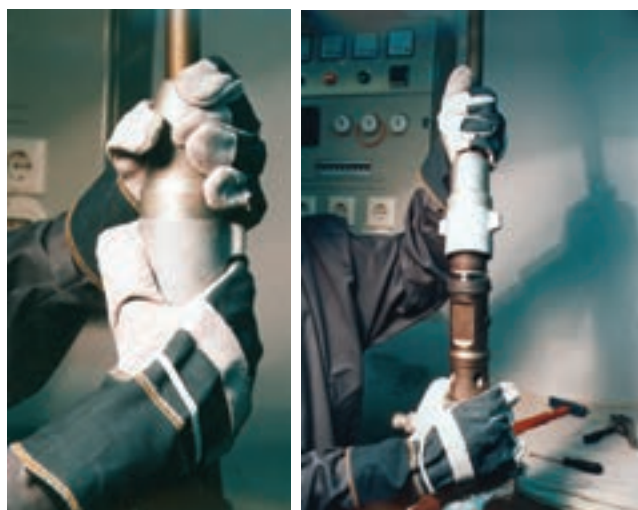
شکل ۲۶-۳- نحوه بستن ته سیلندر (سرپیک)
