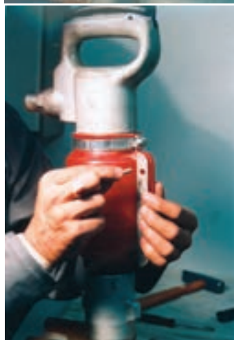
شکل ۲۸-۳- نحوه‌ی جا زدن محافظ
