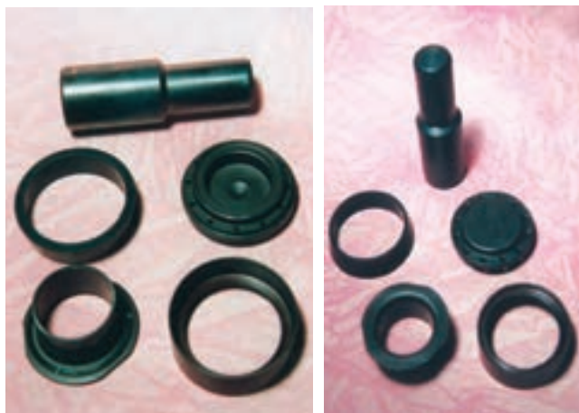
شکل ۱۵-۳- متعلقات و اجزای سیلندر پیکور
