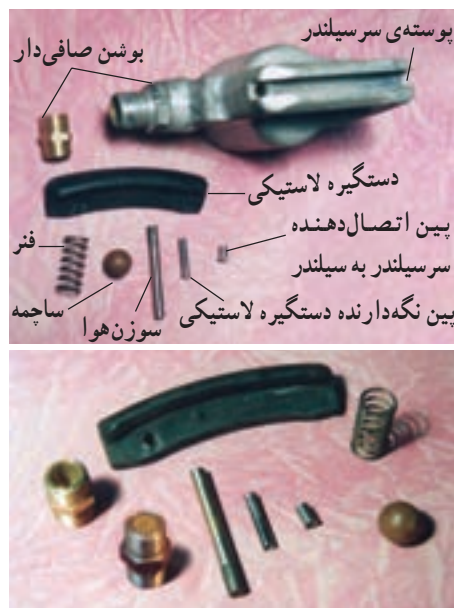
شکل ۹-۳- اجزای مختلف دسته یا سر سیلندر پیکور
