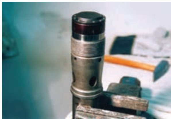
شکل ۲۳-۳- مراحل جازدن درپوش سوپاپ
