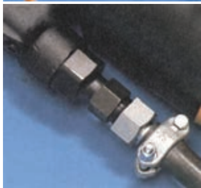
شکل ۳-۴۳- نحوه‌ی بستن پیچ و مهره بست شیلنگ
