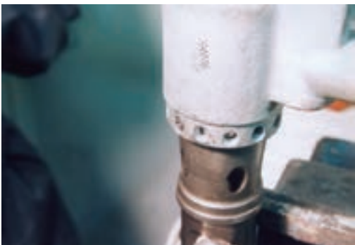
شکل ۲۴-۳- نحوه‌ی بستن سرسیلندر (دسته) به سیلندر و جازدن پین نگه‌دار
