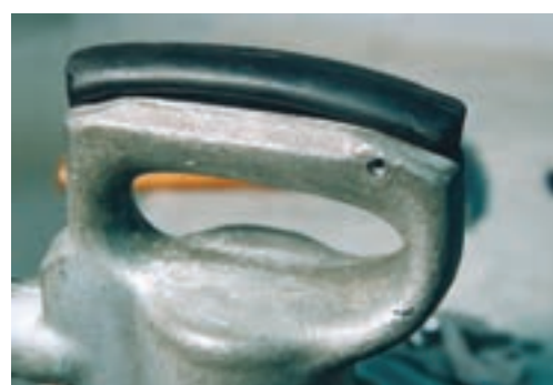
شکل ۱۳-۳- نحوه‌ی جازدن سوزن هوا و دستگیره‌ی لاستیکی
