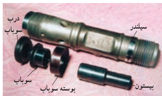
شکل ۱۴-۳- نمای ظاهری سیلندر در دستگاه پیکور
