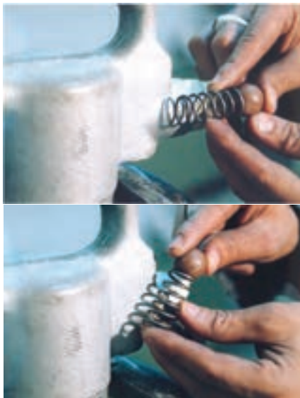
شکل ۱۰-۳- نحوه‌ی جا زدن ساچمه و فنر
