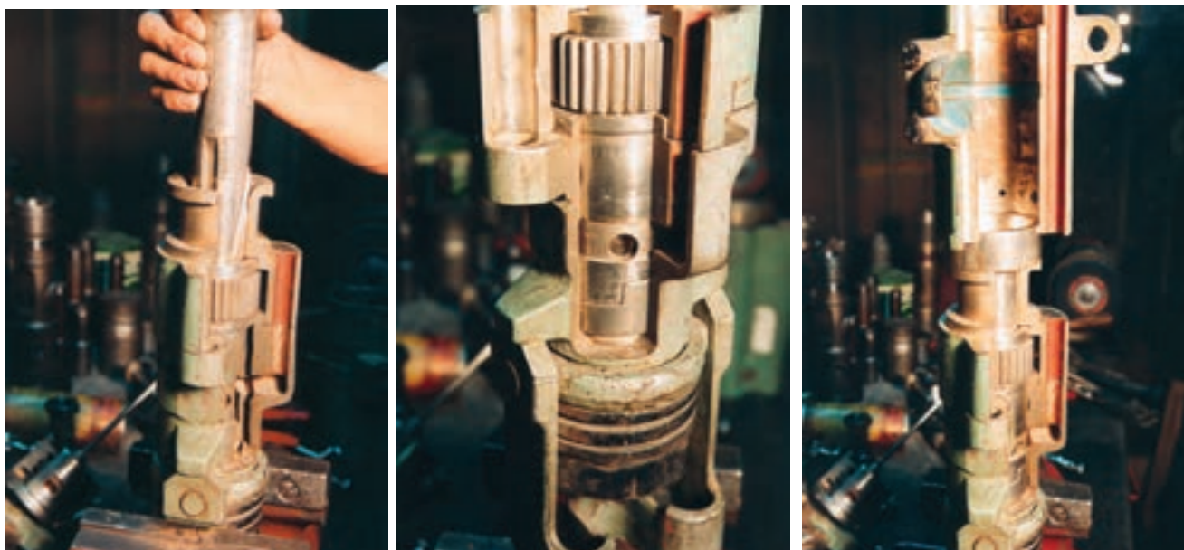
شکل ۱۸-۴- نحوه‌ی جازدن پیستون و پوسته آن
