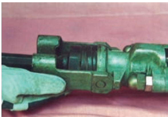
شکل ۲۵-۴- نحوه‌ی تعویض و جازدن مته
