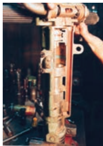
شکل ۲۱-۴- نحوه‌ی جا زدن سرسیلندر
