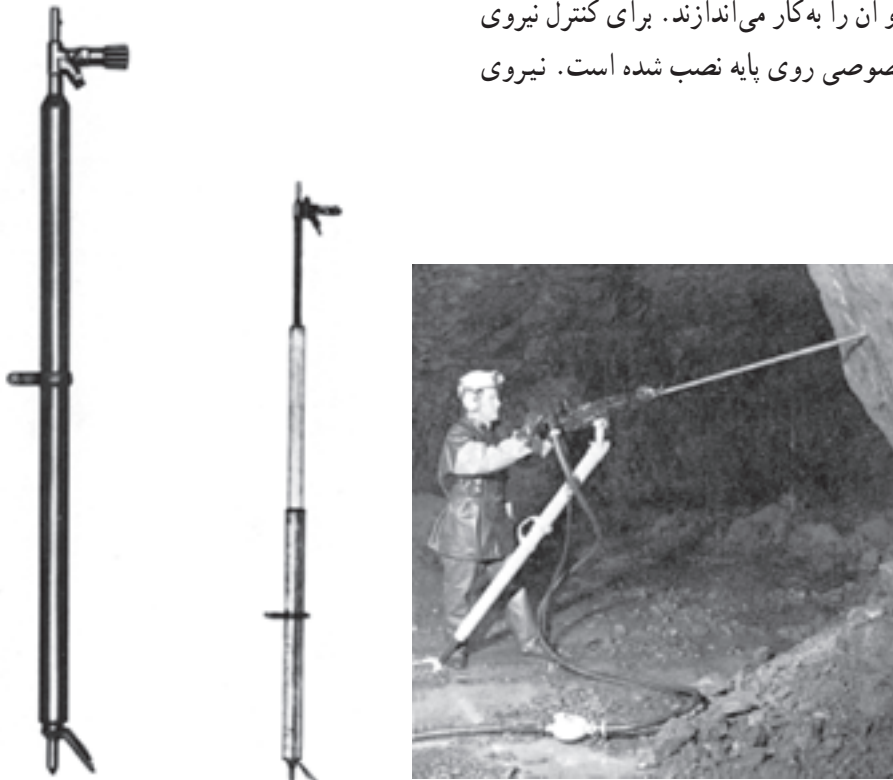
شکل ۲-۷- انواع پایه‌ی انفرادی پنوماتیکی و نحوه‌ی کارکرد با آن
