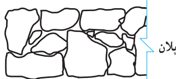
شکل ۵-۲۰- دیوار خشکه چینی سنگی
