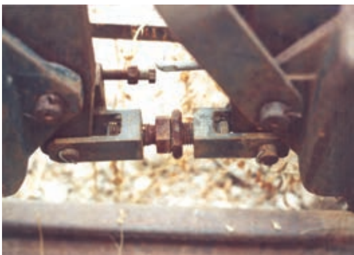
شکل ۲-۳۲- نحوه‌ی عملکرد ترمز لوکوموتیو
