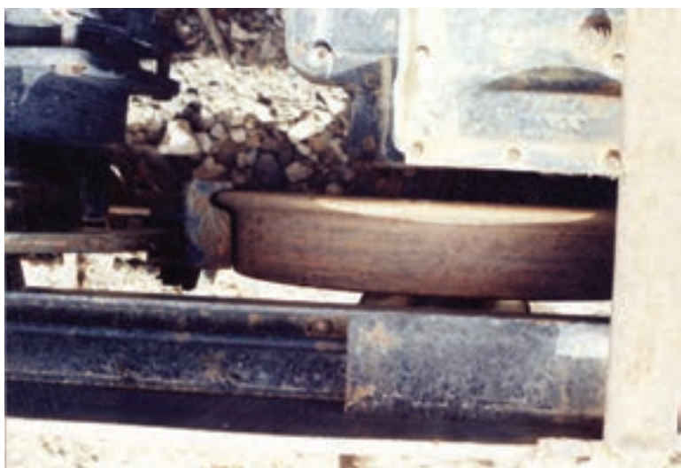
شکل ۳-۳۲- نحوه‌ی عملکرد کفشک‌های ترمز بر روی چرخ
