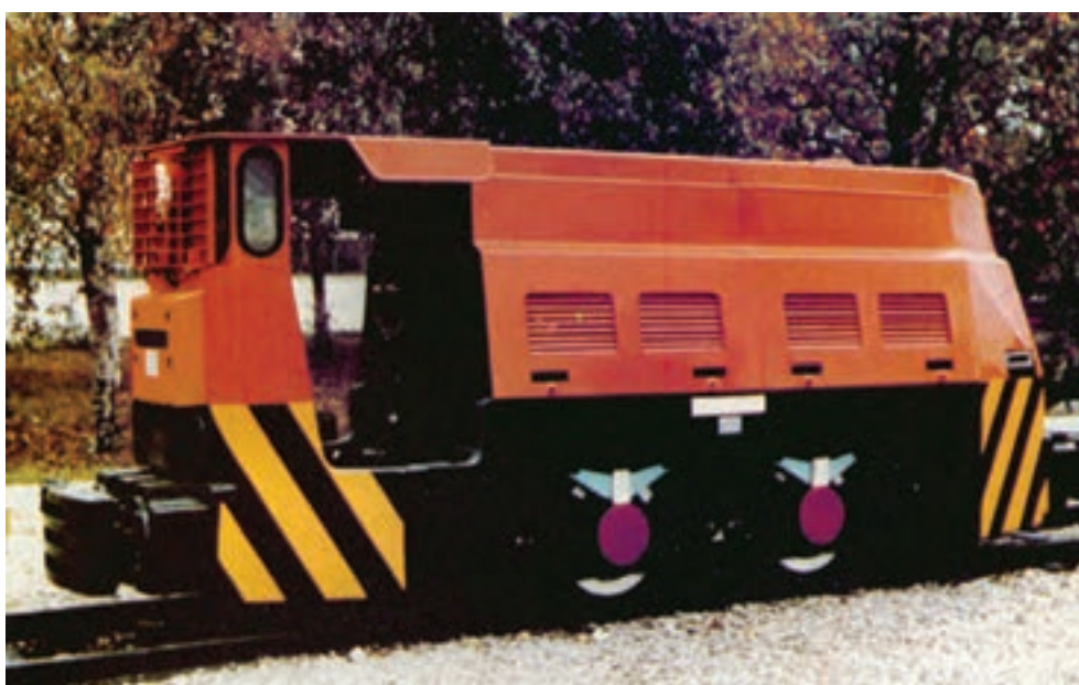
شکل ۸-۳۲- سپر ثابت فولادی و فنردار یا لاستیکی
