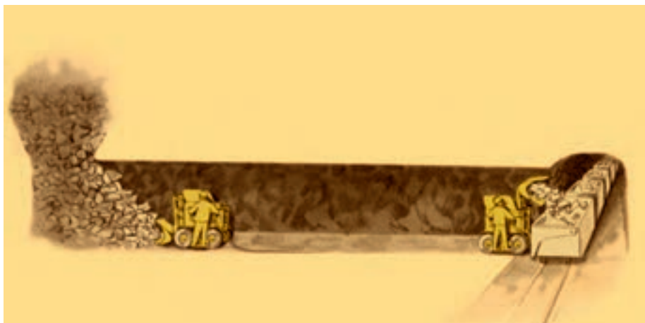
شکل ۶-۳- مراحل کارکرد لودر تونلی (خاک بر سر)
