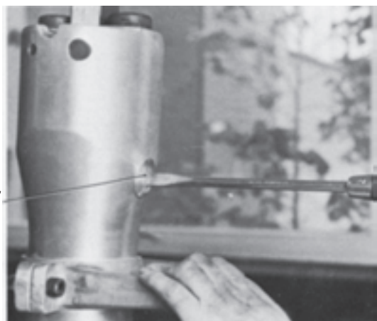
۱۳-۲- و - خارج کردن درپوش جلوی دستگاه ۷- پیچ (۷) را باز کنید.
