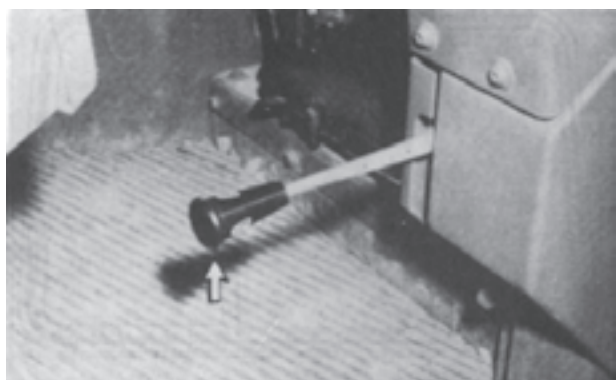
شکل ۱۹-۵- ترمز دستی ترمز دستی: اهرم ترمز دستی علاوه بر درگیر کردن ترمز،
