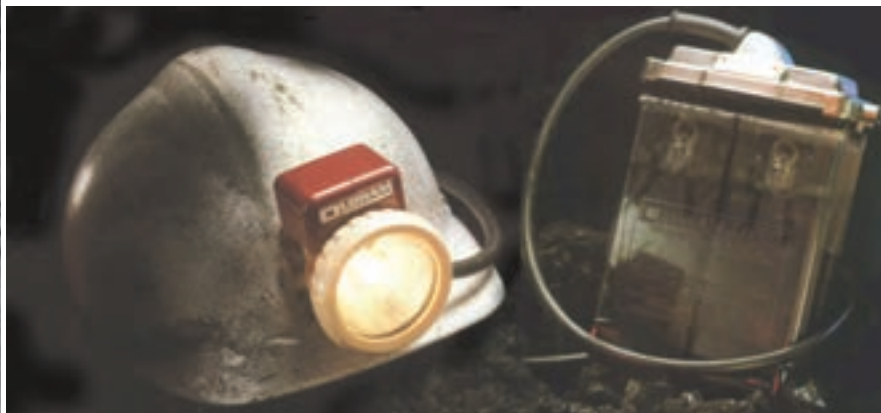
شکل ۷-۱۰- طریقه استفاده از چراغ الکتریکی کلاهی
