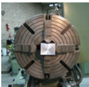
شکل ۲-۱۰ بستن قطعه کار با مقطع مستطیل شکل
