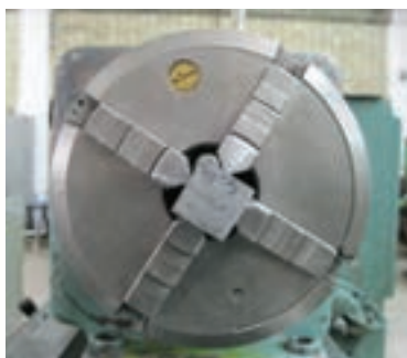
شکل ۲-۷ بستن قطعه کار با مقطع چهارگوش
