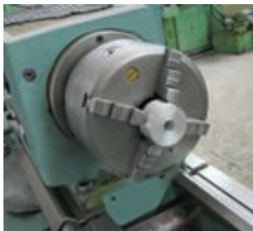
شکل ۲-۸ بستن قطعه کار با مقطع گرد
