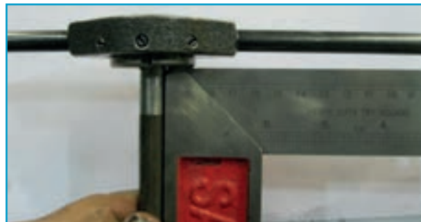
شکل ۶-۱۳ - کنترل عمود بودن محور ميله با دسته حديد
