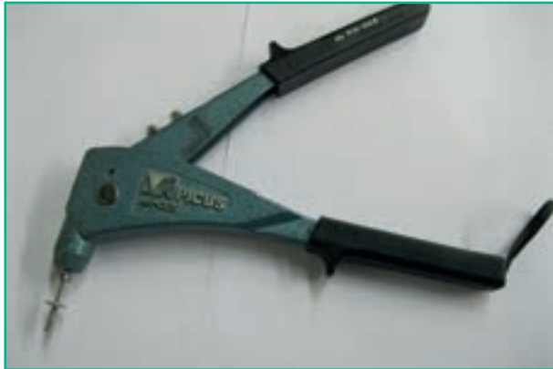
شکل ۷-۱۲- جا زدن پرچ روی انبر پرچ
