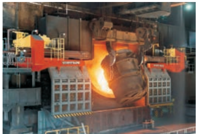
شکل ۱۷-۱ ریختن مذاب در قالب‌های شمش‌ریزی
