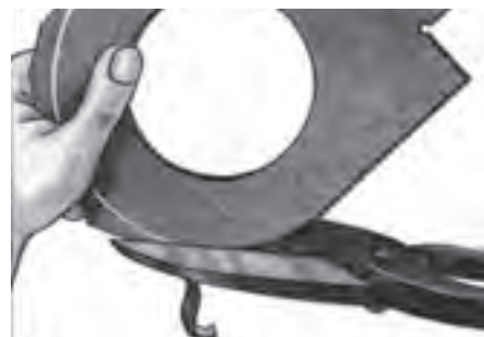
شکل ۳-۶ برشکاری خط‌های منحنی با قیچی تیغه صاف
