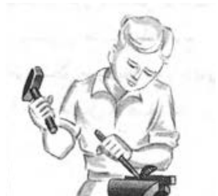
الف) قلم کاری نادرست
