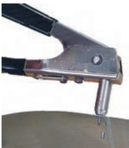
شکل ۵-۱۱ پرچ کش دستی یا ماشینی
