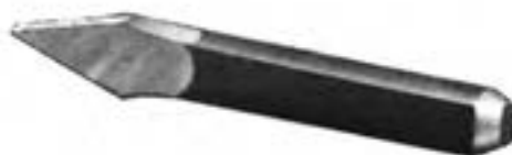
(الف) قلم دم باریک (شیار بُر)
