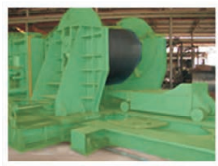
شکل ۴-۱۸ واحد باز کردن ورق ها
