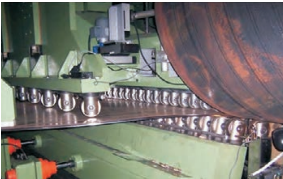
شکل ۴-۲۳-ج شکل دهی لوله‌ها
