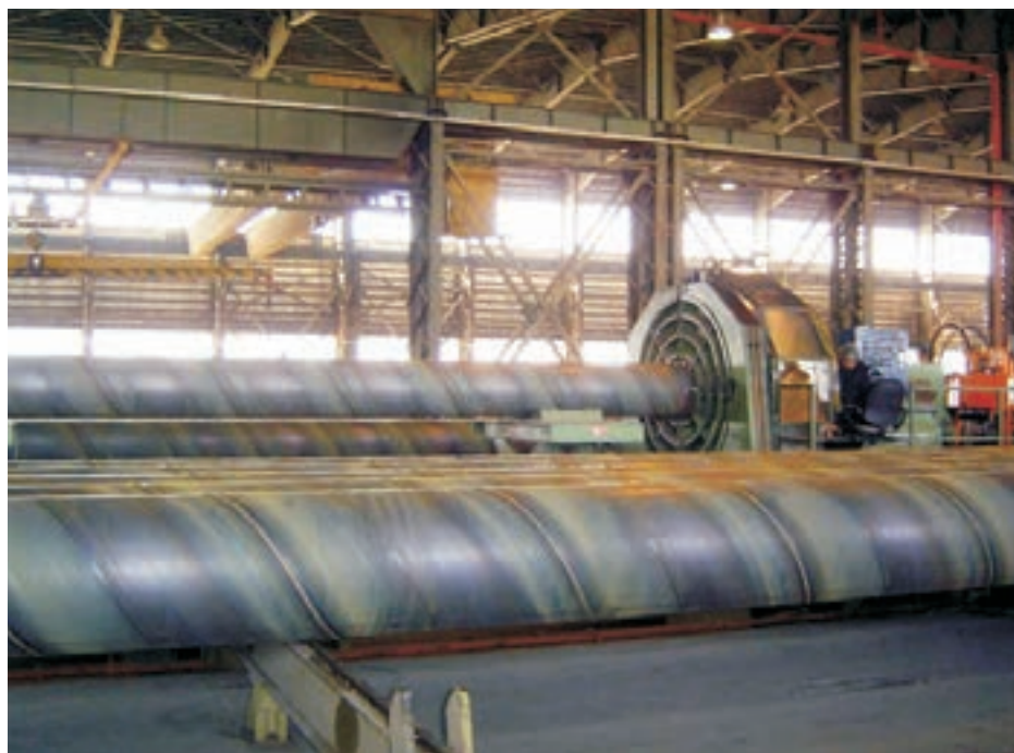
شکل ۴-۳۳ پخ کردن دو انتهای لوله
