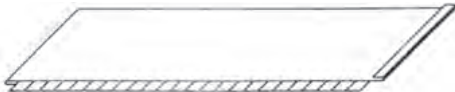
شکل ۶-۱۹ لبه‌های خمکاری شده جهت اتصال فرنگی پیچ
