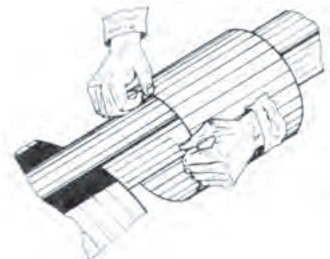
شکل ۶-۲۰ گرد و استوانه کردن گسترش
