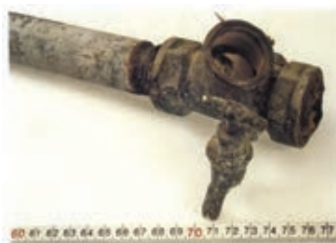
شکل ۷-۱۱- خوردگی لوله فولادی در نزدیکی محل تماس با شیر برنجی
