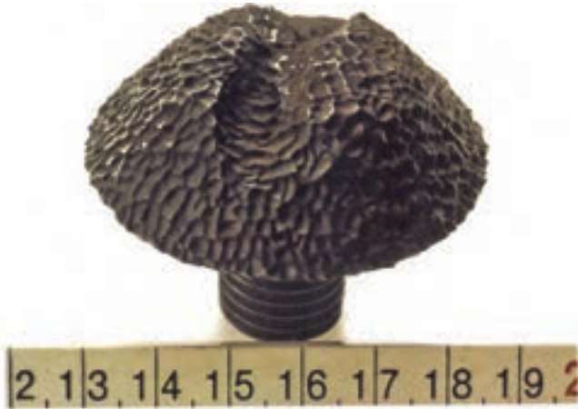
شکل ۲۲-۷- پیچ در محلول خورنده حاوی ذرات ساینده دچار خوردگی فرسایشی شده است.
