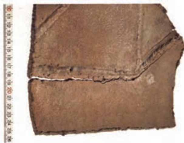
شکل ۱۸-۷- فولاد زنگ نزن در نواحی مجاور خط جوش دچار خوردگی موضعی شده است.
