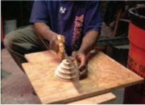
شکل ۲-۸- تهیه مدل ریخته‌گری ماسه‌ای
