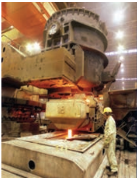
شکل ۱۴-۸- عملیات ذوب‌ریزی از پاتیل حمل مذاب
