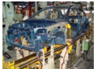
شکل ۹-۴- بدنه خودرو به‌طور معمول از فولادهای میکروآلیاژی (کم آلیاژ) ساخته می‌شود.
