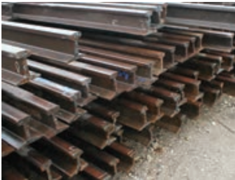
شکل ۲۳-۸- بعضی از محصولات فولادی تولید شده به وسیله عملیات نورد
