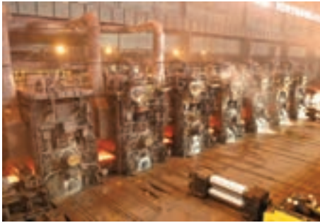
شکل ۲۲-۸- خط نورد گرم در کارخانه فولاد مبارکه اصفهان
