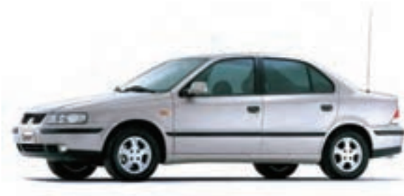
شکل ۹-۴- بدنه خودرو به‌طور معمول از فولادهای میکروآلیاژی (کم آلیاژ) ساخته می‌شود.
