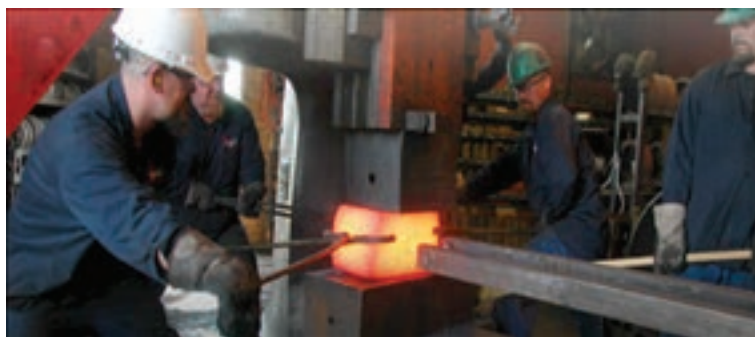
شکل ۸-۱۹- عملیات آهنگری به روش قالب باز برای تولید قطعات صنعتی
