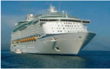
شکل ۹-۲- کشتی مسافربری ساخته شده از آلیاژهای آلومینیومی
