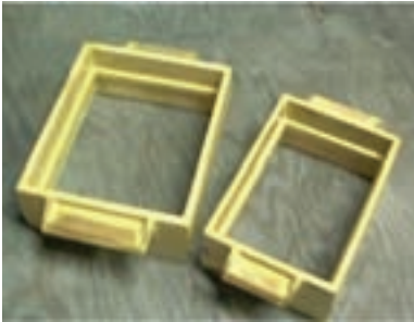
شکل ۳-۸- درجه در ریخته‌گری ماسه‌ای
