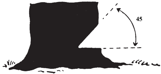
شکل ۱۱-۱- برای قطع درخت ابتدا عمل زیر برش مطابق شکل انجام می‌شود.
