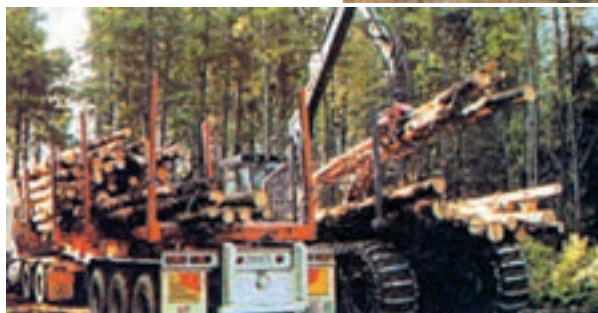
شکل ۱۸-۱- کامیون‌هایی که مجهز به جراثقال هستند گرده‌بینه‌ها را جابه‌جا می‌کنند.
