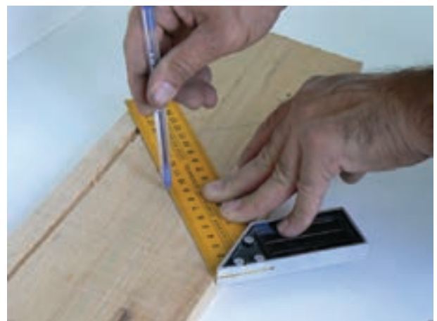
شکل ۱-۵- قسمتهای مختلف یک گونیای ساده و مرکب
