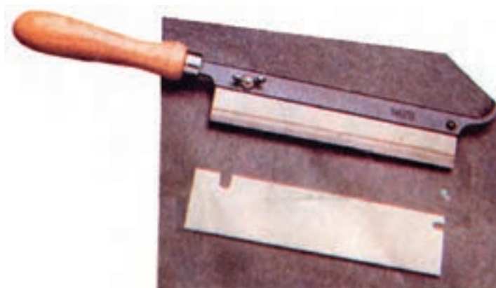
شکل ۲-۱۳- اره ظریف بر با دسته متحرک
