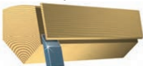
تراشه‌زنی در جهت بینابینی (به صورت عرضی)
