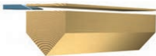
تراشه‌زنی در جهت مماس بر دایر سالیانه (به صورت عرضی)
