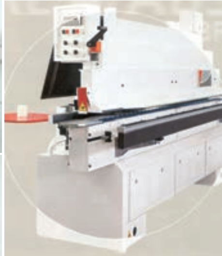
شکل ۶۹-۱- دستگاه پی‌وی‌سی زن (این دستگاه در انواع ایرانی و خارجی ساخته می‌شود) و نمونه‌هایی از روکش‌های پلی‌وینیل کلراید و کاغذی
