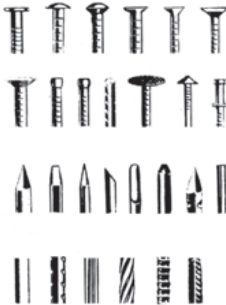
شکل ۲-۹۱- سرهای مختلف، ساق‌ها و نوک انواع میخ‌ها
