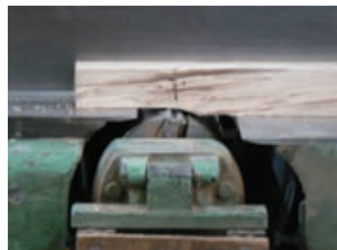
شکل ۵-۲ - طریقه صحیح نصب تیغه
