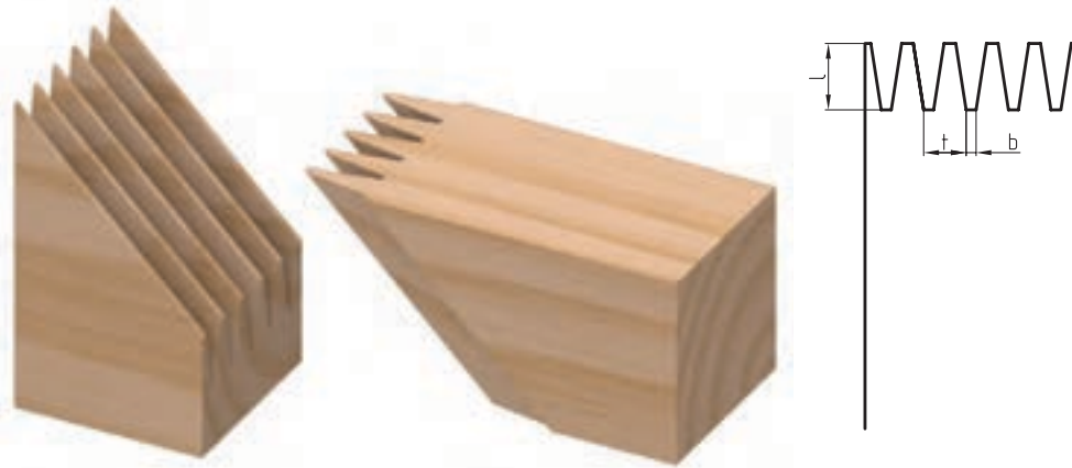
شکل ۹-۳۰. اتصال گوشه‌ای شانه‌ای، در سه اندازه‌ی مختلف
