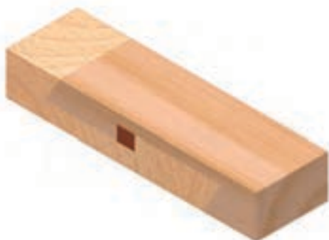
شکل ۹-۷۶- اتصال طولی گوه‌ای سر کج.
