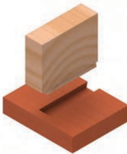
شکل ۹-۶۰- طریقه‌ی ترسیم اتصال گوشه‌ی صفمات گرات یک طرفه، با درز پایینی.
