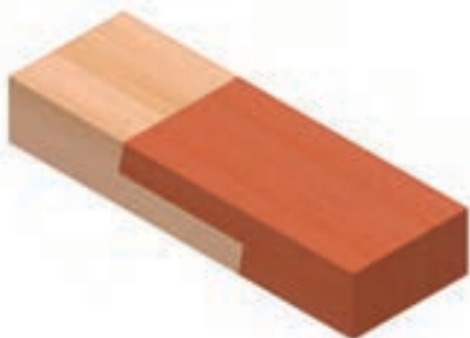
شکل ۹-۷۴- اتصال طولی نیم و نیم سرکج.
