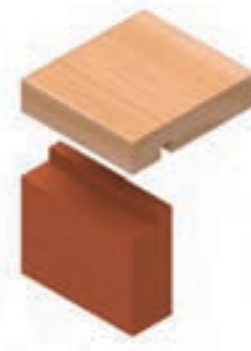
شکل ۹-۱۴۶- اتصال گوشه‌ی صفمات دو رو مففی (فارسی)، با دو کنشکاف و دو زبانه.
