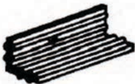
شکل ۹-۶۴- طریقه‌ی ترسیم اتصال گوشه‌ی صفمات قلیف، با زبانه‌ی پیش ساخته از مواد مصنوعی در نما.
