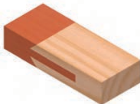
شکل ۹-۷۷- اتصال طولی فاق و زبانه‌ی سرکج.
