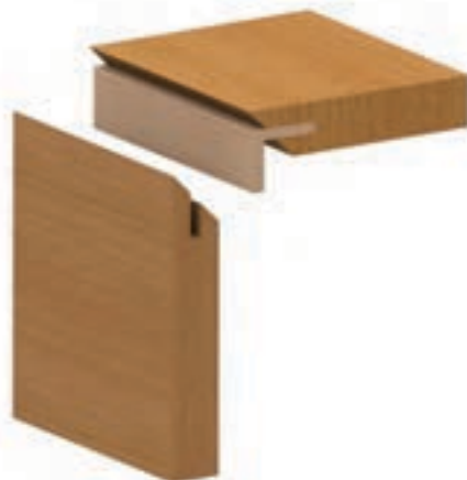
شکل ۹-۶۳- اتصال گوشه‌ی صفمات قلیف، با زبانه‌ی پیش ساخته از مواد مصنوعی.
