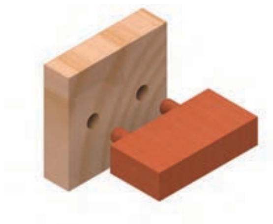
شکل ۹-۵۲- اتصال گوشه‌ی صفمات دوبر با افتلاف سطح.
