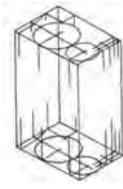
شکل ۱-۳۲- روش ترسیم طرح اولیه تصویر مجسم ایزومتریک، قطعه ابزار خورده
