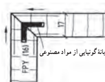
شکل ۲-۶۶- ترسیم علائم اتصال قلیف زبانه سراسری از جنس مواد مصنوعی
