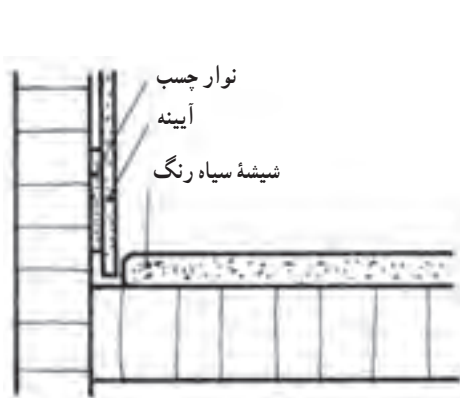
شکل ۲-۳۱- ترسیم علائم صفحات چوبی با نصب آینه و شیشه سیاه رنگ
