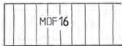
شکل ۲۸-۲ ترسیم نقشه تخته فیبر با دانسیته متوسط MDF
