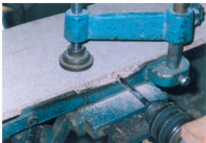
شکل ۲۴ - سوراخ کردن محل اتصال دوبل به وسیله‌ی ماشین مته کم‌کنی
