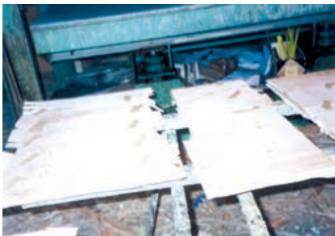
شکل ۲۱- قرار دادن صفحات در محل مسطح برای خنک شدن
