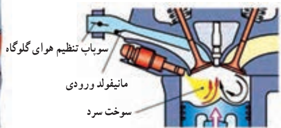
شکل ۲۰-۱- اشکال مختلف محفظه احتراق به منظور اختلاط بهتر سوخت و هوا
