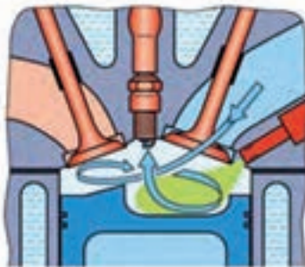
شکل ۲۰-۱- اشکال مختلف محفظه احتراق به منظور اختلاط بهتر سوخت و هوا
