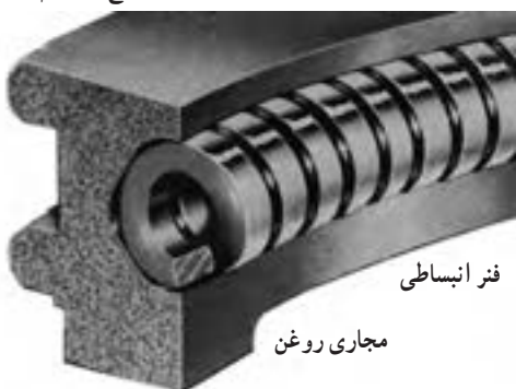
شکل ۲-۴۴- شکل قرار گرفتن رینگ‌ها در پیستون
