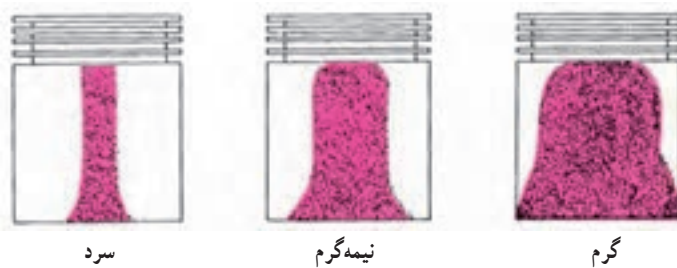
شکل ۳۴-۲- سطوح تماس بیستون بیضی شکل از حالت سرد بودن تا گرم شدن کامل
