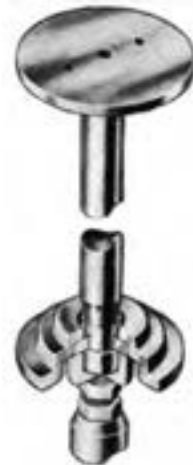
شکل ۲۵-۲- ساختمان سوپاپ گردش آزاد
