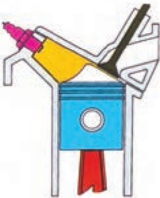
شکل ۱۱-۲- انواع اتاق احتراق در سیستم I شکل
