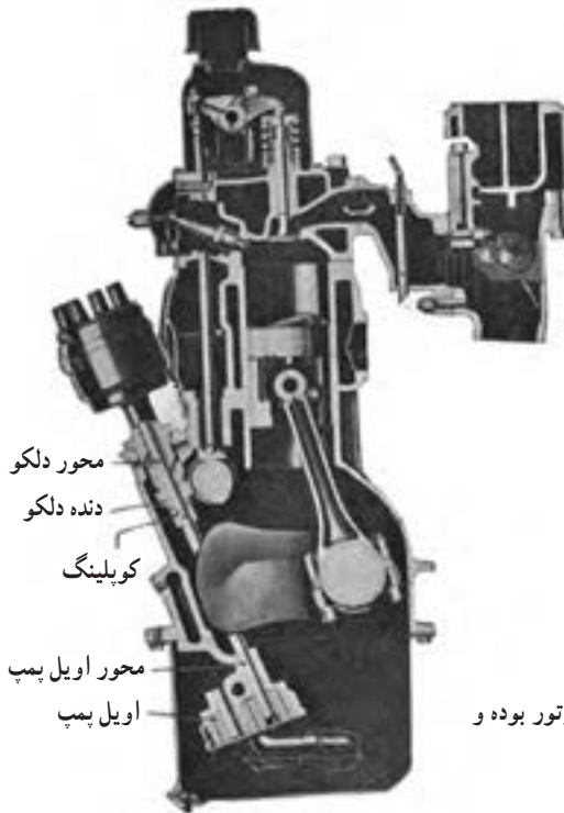
شکل ۱۳-۴- اویل پمپ خارج از موتور قرار داشته و از میل سوپاپ نیرو می گیرد.
