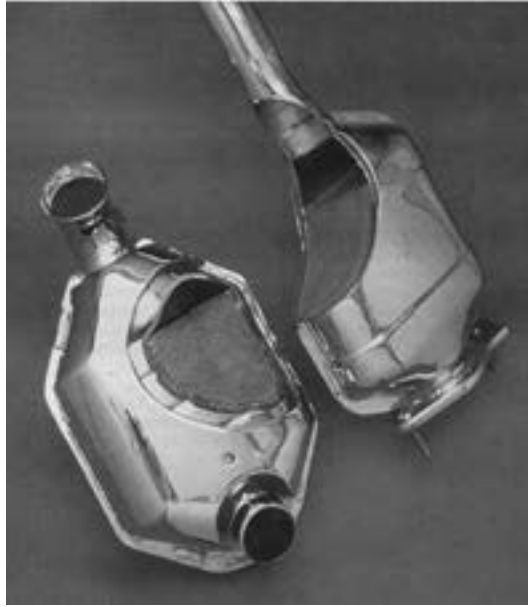
شکل ۷-۵- تصویر برش خورده یک مبدل کاتالیستی
