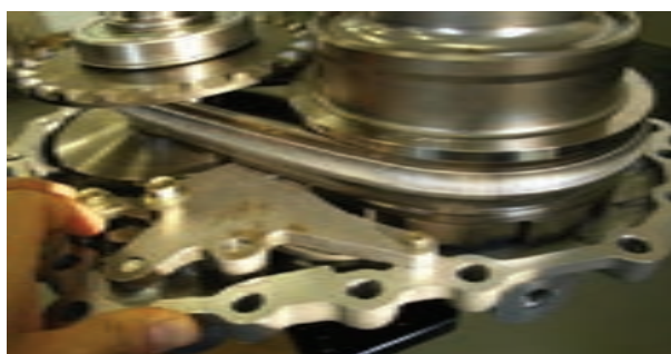
شکل ۵-۹- انتقال توان بین پولی محرک و متحرک توسط تسمه فولادی
