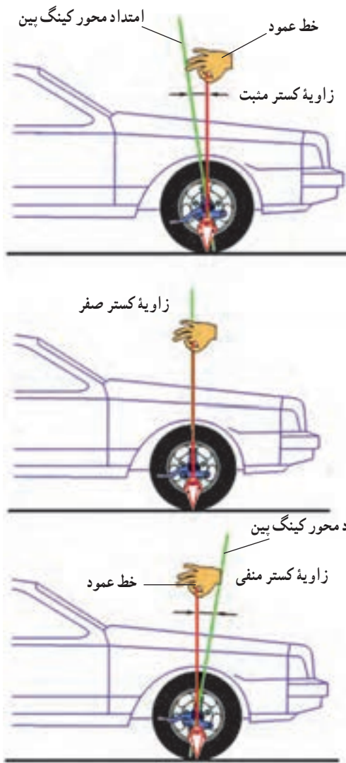
شکل ۷-۱۳- انواع حالت‌های زاویه کستر
