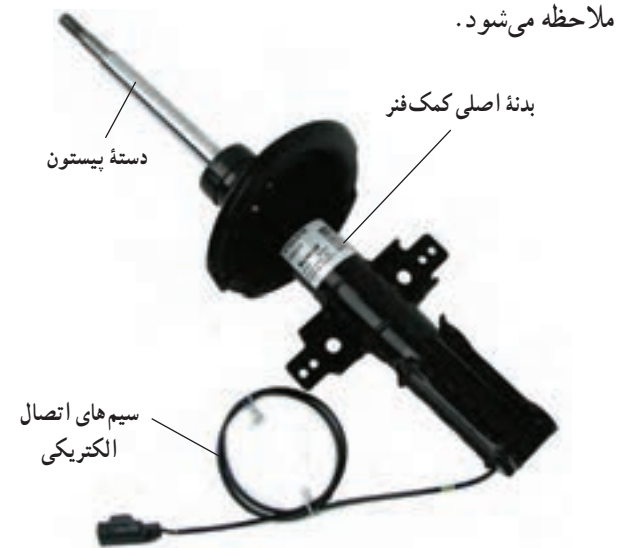
شکل ۷-۲۴- ساختمان ظاهری کمک فنر قابل تنظیم پیوسته از نوع ام آر (MR)
