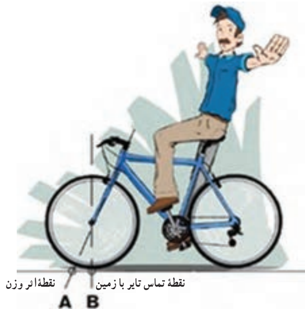
شکل ۷-۱۴- تأثیر زاویه کستر مثبت در پایداری سویی خودرو
