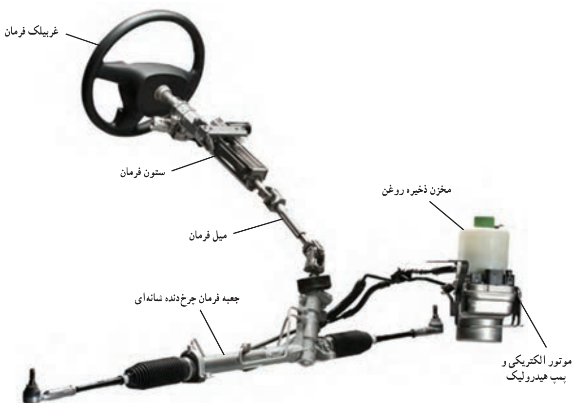
شکل ۱۹-۸- ساختمان ظاهری فرمان الکترو هیدرولیکی
