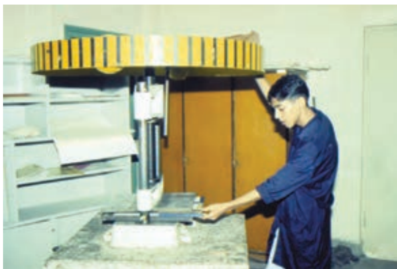
شکل ۱-۱۱- نمونه‌ای از پرس فلکه‌ای (دستی)
