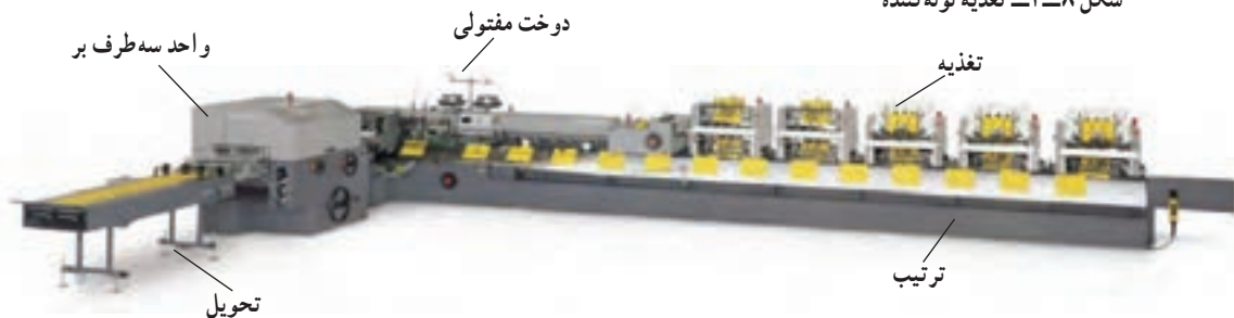
شکل ۹-۴- خط تولید مفتول دوزی، ترتیب - دوخت مفتولی
