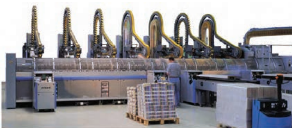
شکل ۴-۱۱- استوانه‌ی زینی دوخت مفتولی برای تولید مجله
