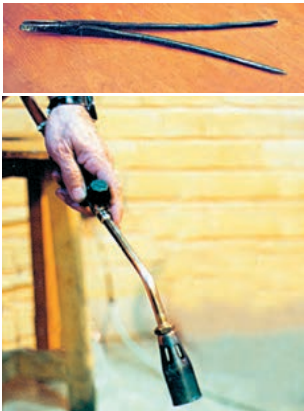
شکل ۸-۶- انبر و مشعل از ابزار و وسایل مورد استفاده در روش ریختگی
