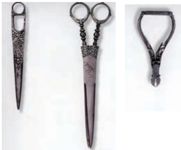
شکل ۶-۷- ب - انواع ابزار و وسایل فلزی ساخته شده به روش ریختگی
