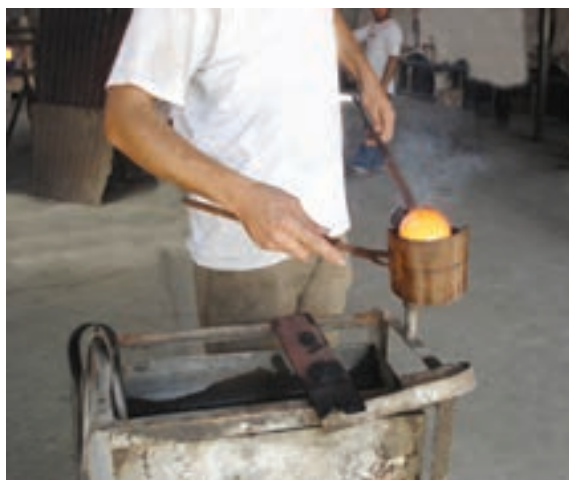
شکل ۷-۸- قاشقی کردن بار
