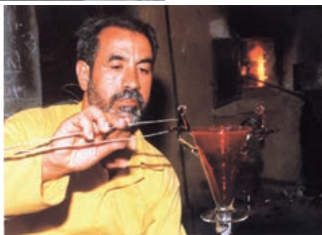
شکل ۷-۱۳- مراحل شکل‌دهی دهانه‌ی شیء
