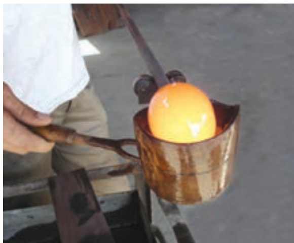
شکل ۷-۸- قاشقی کردن بار
