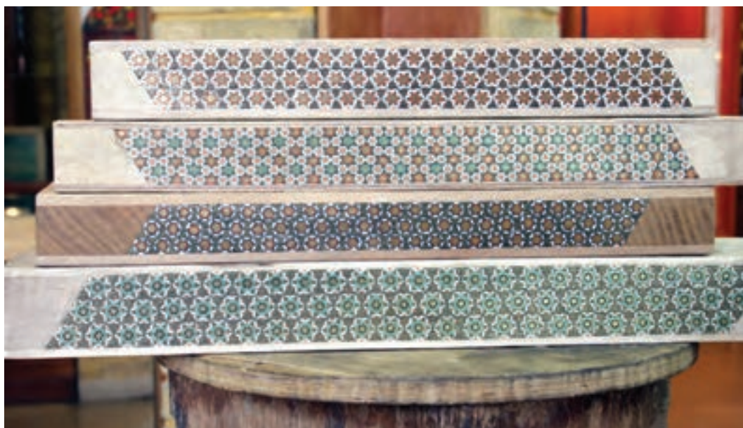
شکل ۲۵-۸-ج- قامه بندی، پرس و برش طولی قامه
