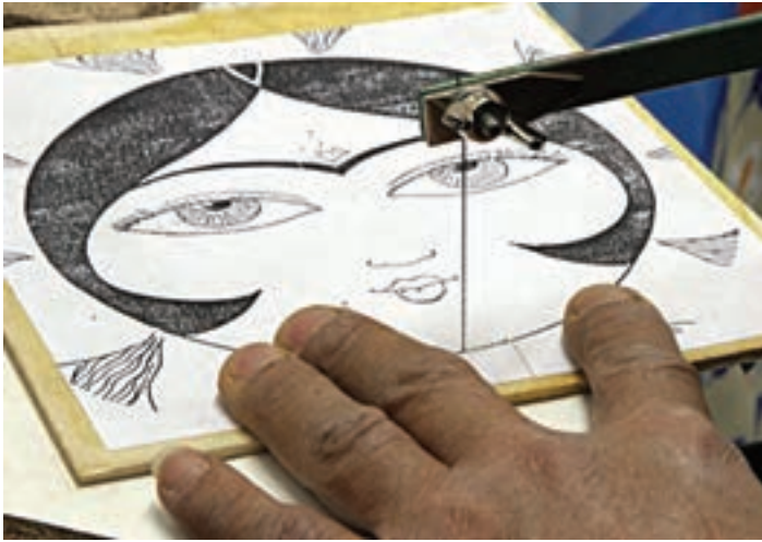
شکل ۲۰-۸-الف - طرح کاغذی چسبانده شده بر قالب یا تخته سه لایی
