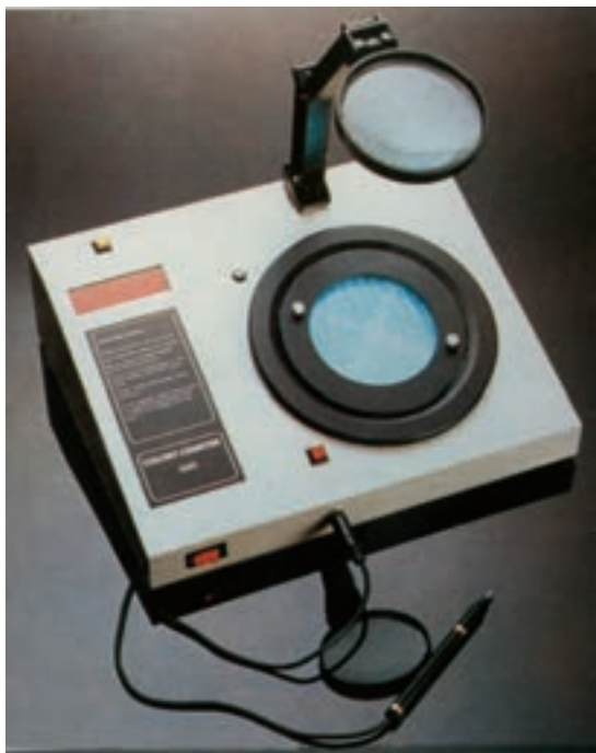
شکل ۲-۶- دو نمونه از پرگنه‌شمار یا کلنی‌کانتر آزمایشگاه میکروبیولوژی
