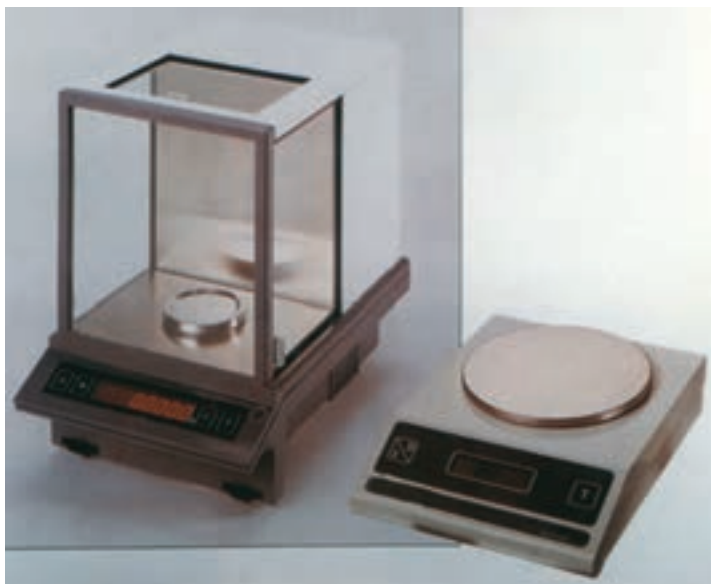
شکل ۵-۲- نمونه‌ای از ترازوی دیجیتال مخصوص وزن کردن مواد در آزمایشگاه
